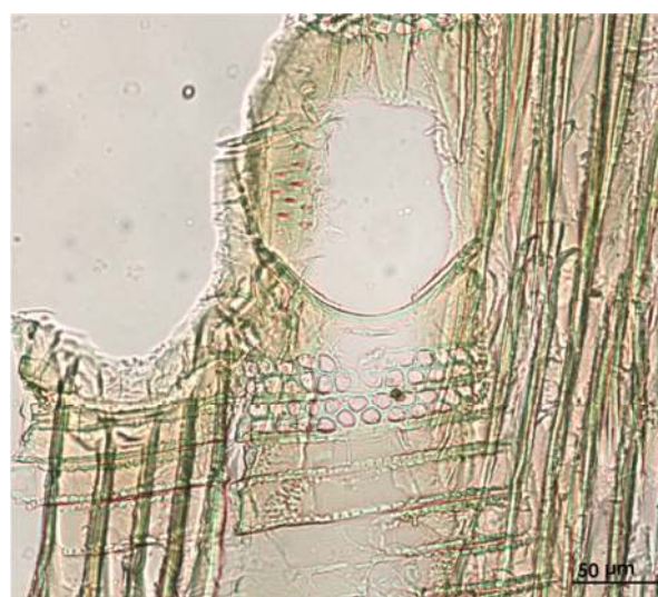
Figura 6 - Pioppo ( Populus sp.). Camp. n. 1, tavola. Sezione radiale ripresa al microscopio ottico. Vaso con placca di perforazione semplice e punteggiature intervascolari grandi, a disposizione alterna. Raggio omocellulare con punteggiature raggio-vaso grandi
