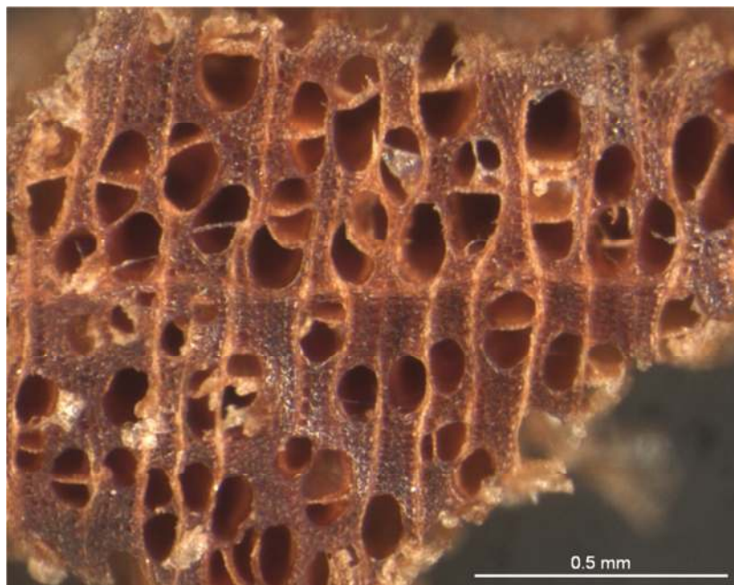
Figura 4 - Pioppo ( Populus sp.). Camp. n. 1, tavola. Sezione trasversale ripresa allo stereomicroscopio in luce riflessa. Legno eteroxilo a porosità diffusa con vasi piuttosto piccoli, uniformemente distribuiti nell'anello di accrescimento. Raggi parenchimatici monoseriati
